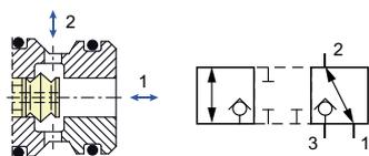
Mit der Ausführung „Positivkolben“ wird eine gesperrte Übergangstellung erreicht, d.h. dass während der Schaltzeit keine Verbindung zwischen den Anschlüssen 3, 2 und 1 besteht und daher nur ein geringer Schaltölverlust auftritt. Dies ist sehr wichtig bei kleinvolumigen Anlagen oder bei Speicher- und Spannsystemen.
